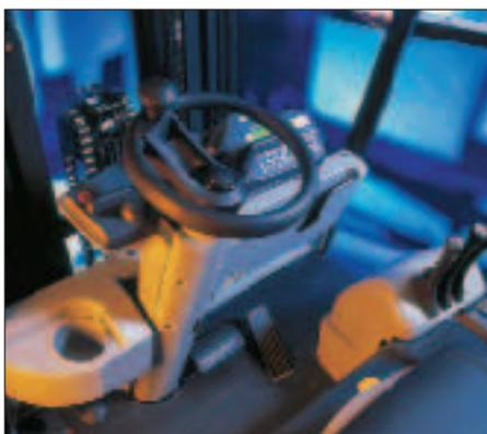
● Das Fahrpedal gibt die vom Fahrer gewünschte Geschwindigkeit vor. Last- und fahrbahnabhängige Einflüsse verändern die Fahrgeschwindigkeit nicht.
